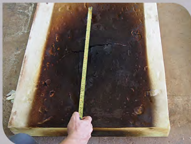
Figure 13 Flame spread characteristic of specimen 2 รูปที่ 13 ลักษณะ:การลามไฟของตัวอย่างที่ 2
