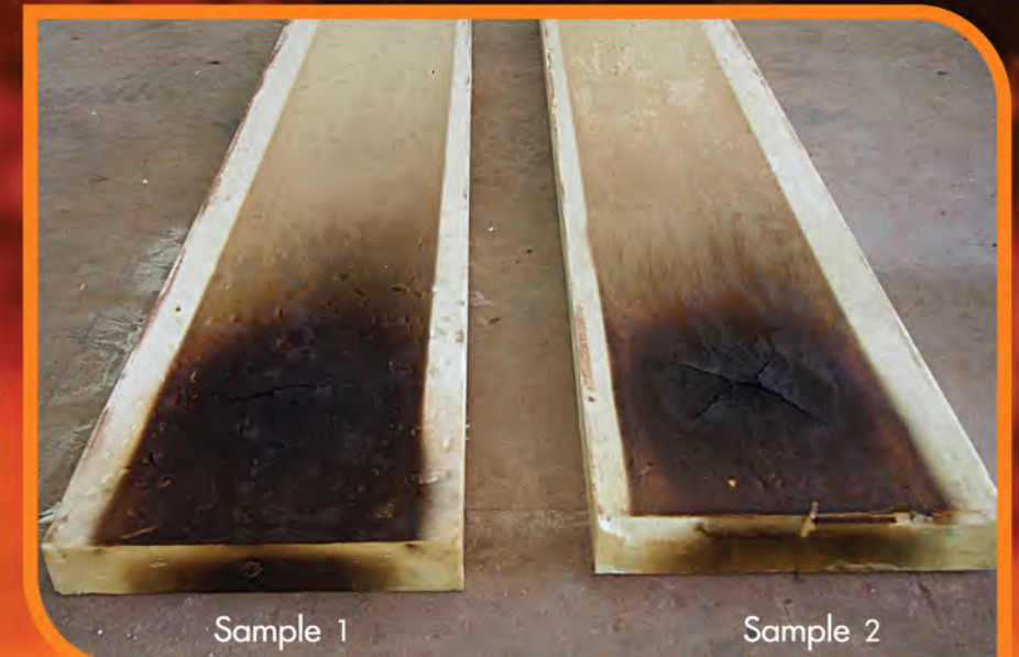
Figure 14 Comparison of flame spread characteristic of specimen 1 and 2 รูปที่ 14 การเปรียบเทียบลักษณะ:การลามไฟ ของตัวอย่างที่ 1 และตัวอย่างที่ 2
